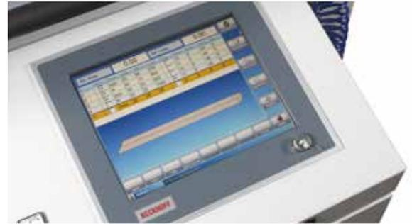
Programmateur BECKHOFF à écran tactile de 12" à haute résolution et interface graphique 3-D sous système d'exploitation Windows.
